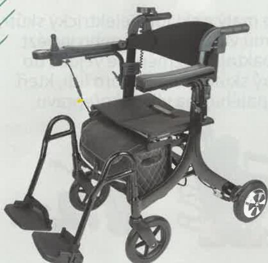
Eroute 9000SW můžete využít jako **chodítka, vozík** nebo **rehabilitačního asistenta**. Elektrický skládací invalidní vozík Eroute 9000SW s výkonným motorem, lithium-iontovými bateriemi, **dojezdem až 25 km, nosností až 130 kg** a zárukou 2 roky vám díky funkčním předním a zadním tlumičům zajistí tu nejvhodlnější jízdu.
