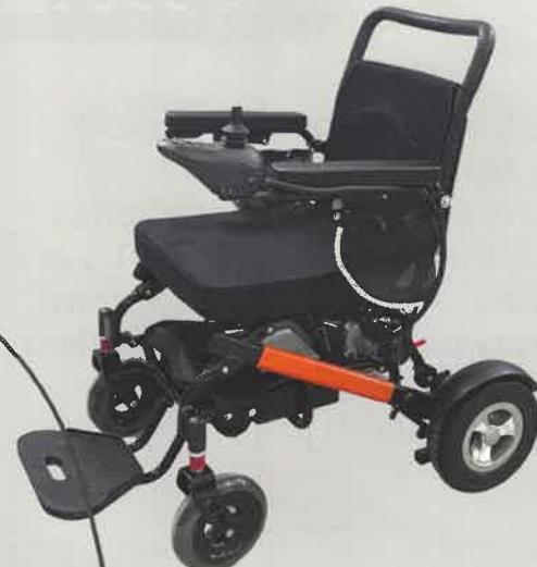
Elektrický invalidní vozík 530M lze **ručně skládat** a **ovládat druhou osobou pomocí ovladače**. Budte mobilní za každé situace a dopřejte si vysoký komfort. Model Eroute 530M se výborně hodí při cestování autem, autobusem, vlakem i letadlem. Elektrický skládací invalidní vozík Eroute 530M s výkonným motorem, lithium-iontovými bateriemi, **dojezdem až 25 km**, **nosností až 130 kg** a zárukou 2 roky vám díky funkčním předním a zadním tlumičům zajistí tu nejohodlnější jízdu.
